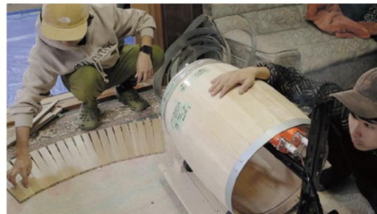
●試行錯誤の末、自作の赤外線ヒーターによる火入れ技術も確立。
